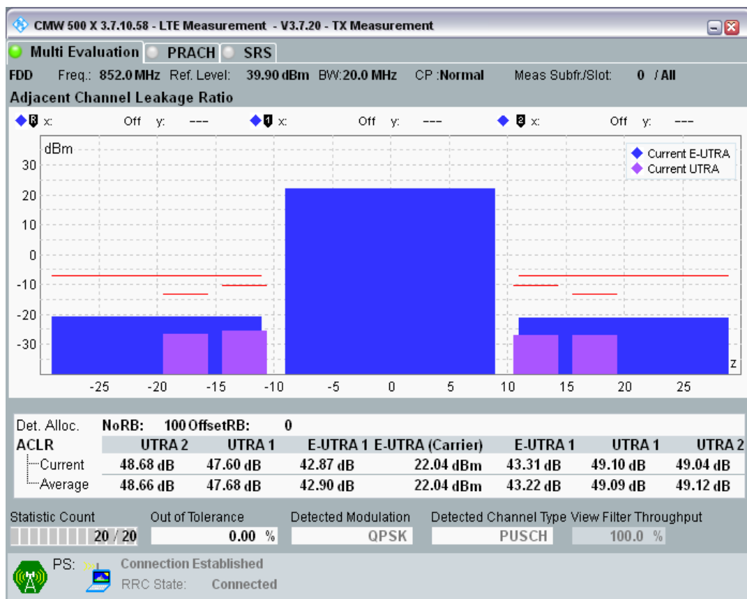
Band20 QPSK BW=20MHz Channel=24350 RB Size=18 Position=#0.png
