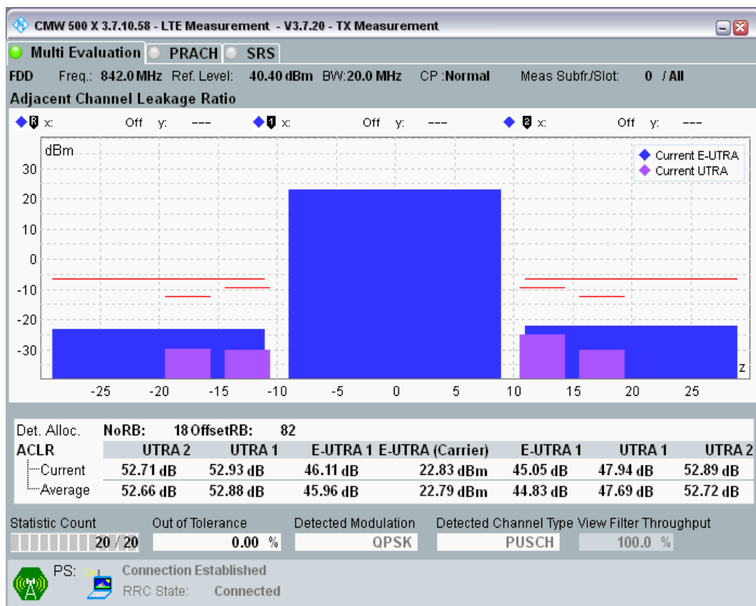
Band20 QPSK BW=20MHz Channel=24300 RB Size=100 Position=#0.png
