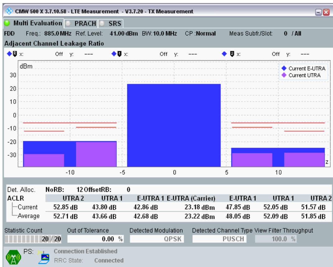
Band8 QPSK BW=10MHz Channel=21500 RB Size=12 Position=#Max.png
