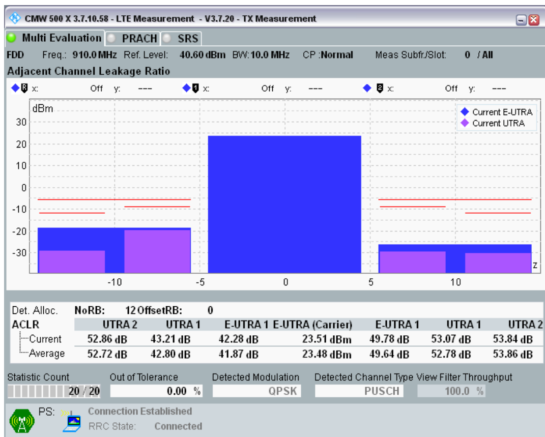
Band8 QPSK BW=10MHz Channel=21750 RB Size=12 Position=#Max.png
