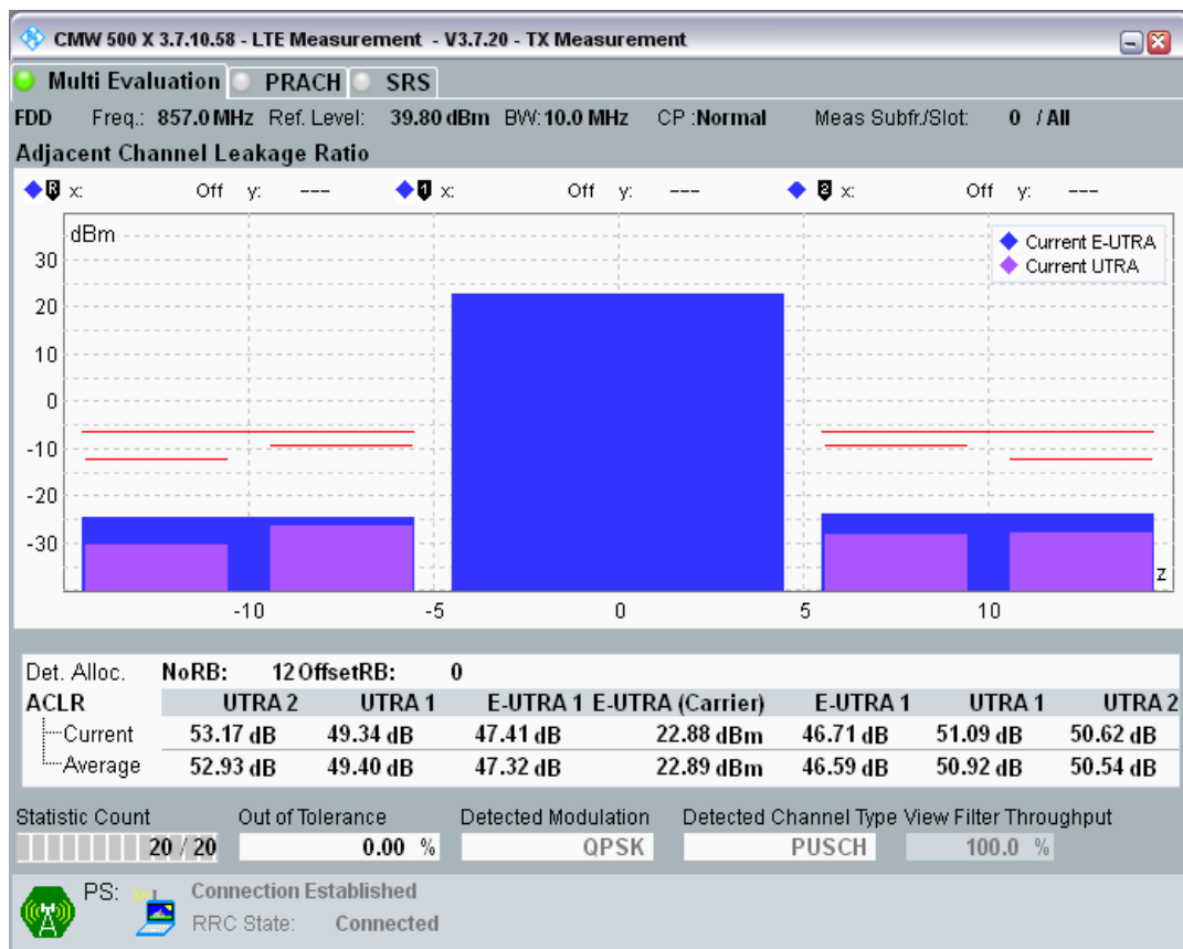
Band20 QPSK BW=10MHz Channel=24400 RB Size=12 Position=#Max.png
