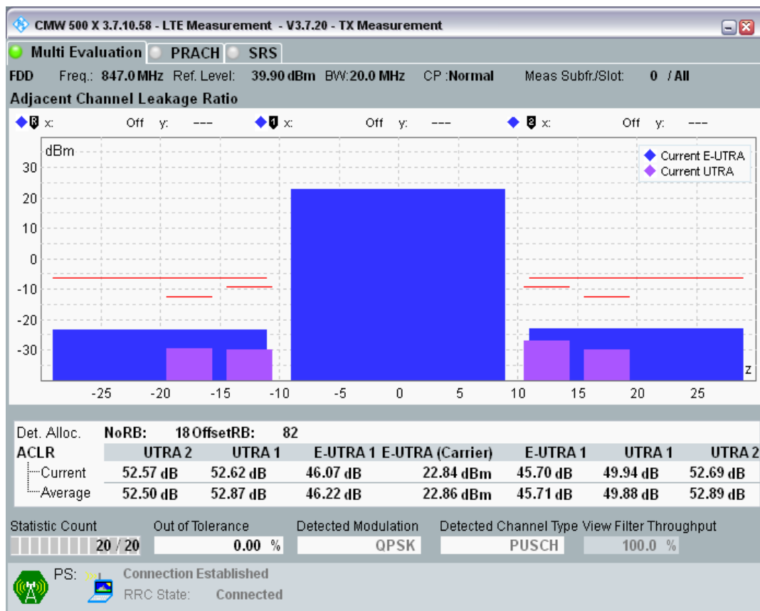
Band20 QPSK BW=20MHz Channel=24350 RB Size=100 Position=#0.png
