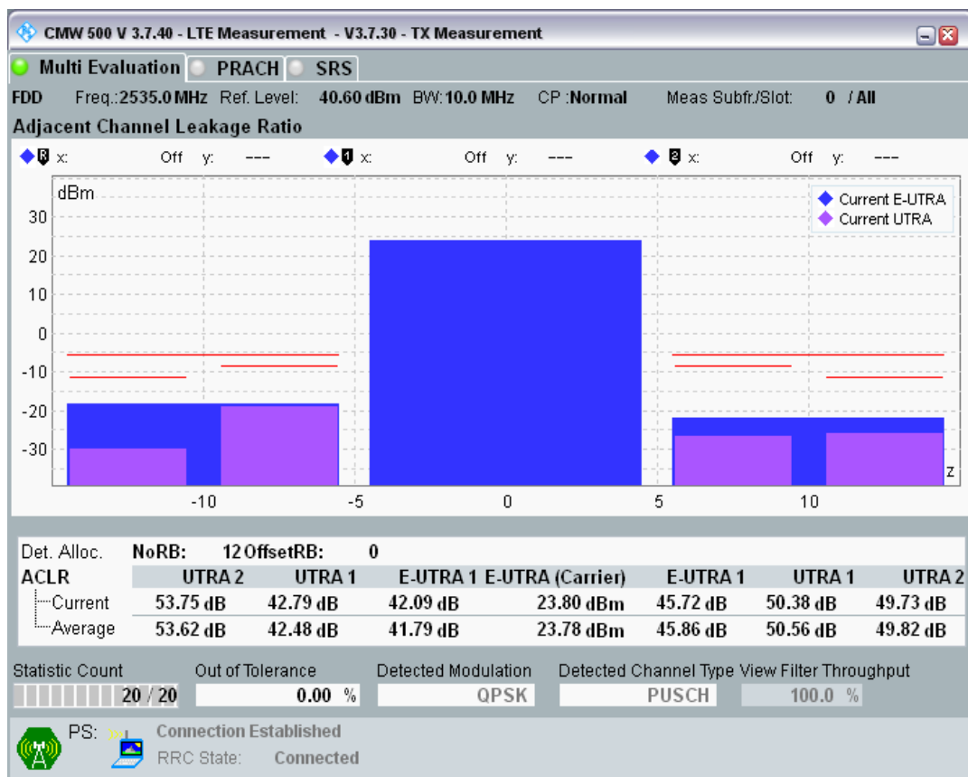
Band7 QPSK BW=10MHz Channel=21100 RB Size=12 Position=#Max.png
