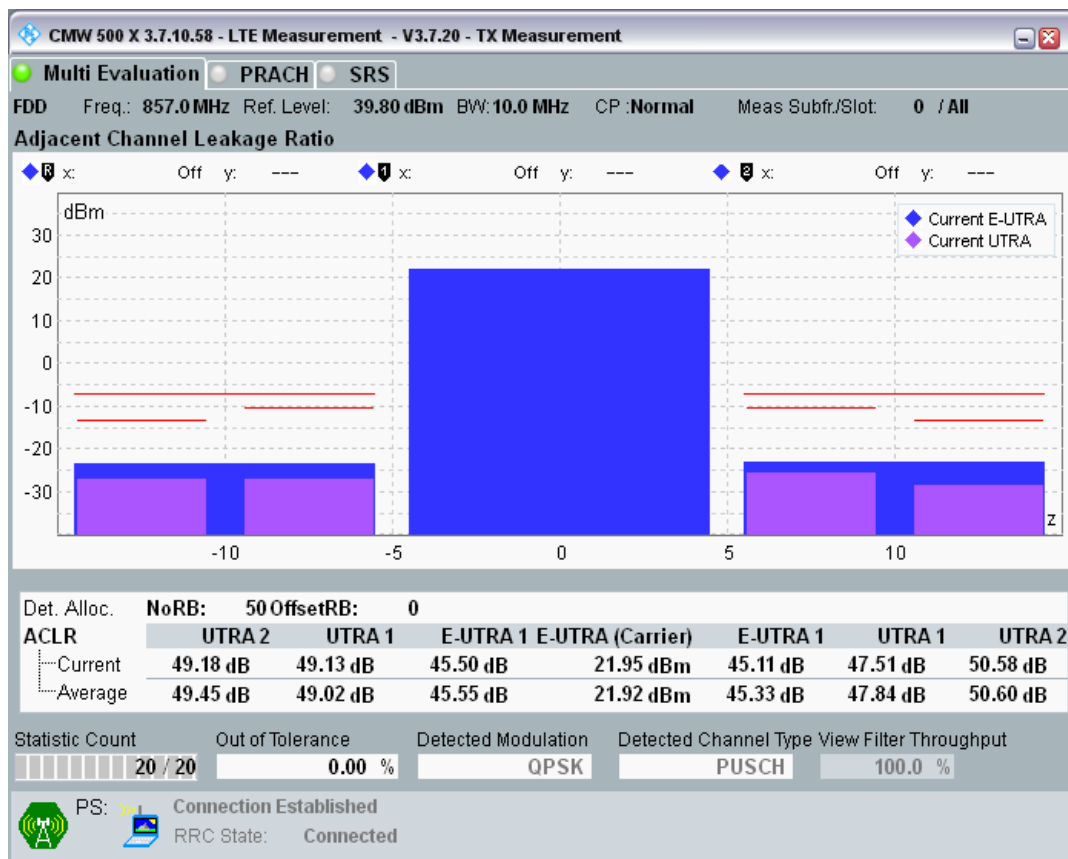
Band20 QPSK BW=20MHz Channel=24250 RB Size=100 Position=#0.png
