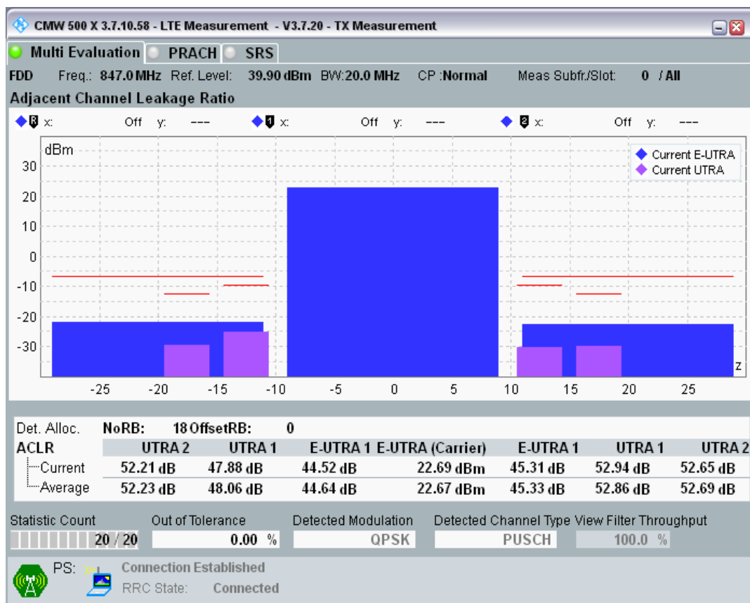
Band20 QPSK BW=20MHz Channel=24300 RB Size=18 Position=#Max.png
