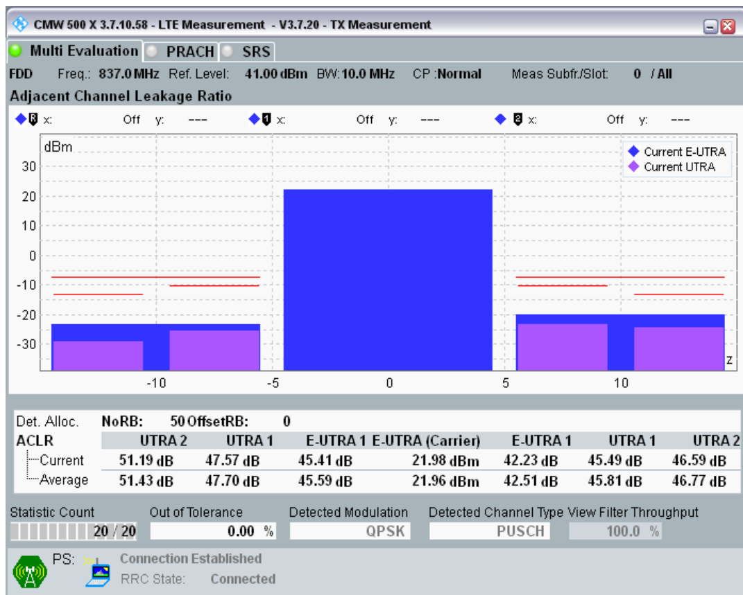
Band20 QPSK BW=10MHz Channel=24300 RB Size=12 Position=#0.png
