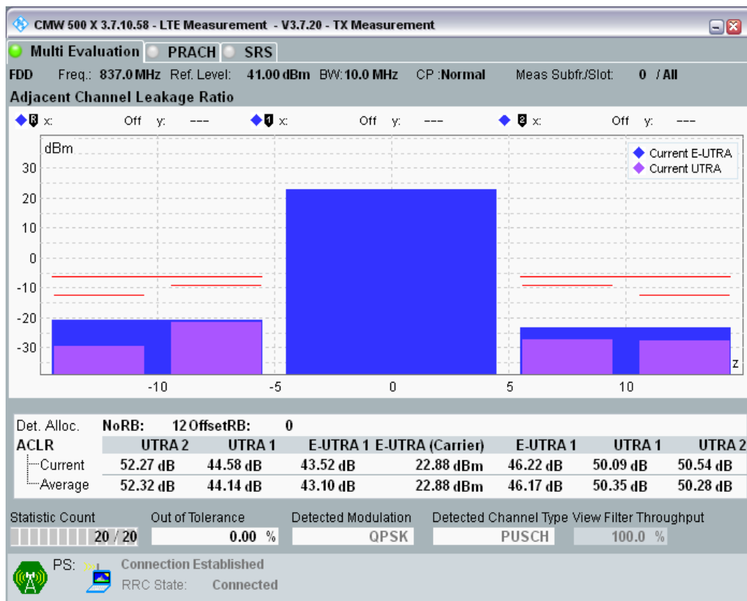
Band20 QPSK BW=10MHz Channel=24200 RB Size=12 Position=#Max.png
